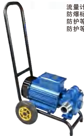
防爆标志: Ex d IIB T4 Gb 防护等级: IP55 电压: 220V
